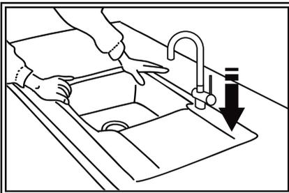
7) Umetnite sudoper u otvor na radnoj površini, pritisnite prema dolje i pustite da se silikon osuši 30 minuta
