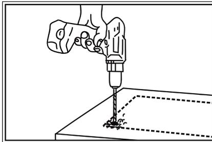
2) Uporabom bušilice napravite rupe u uglovima obrisa (s njegove unutrašnje strane)
