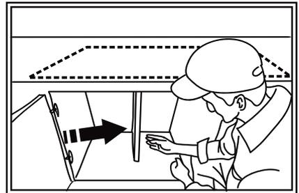
3) Postavite stalak ispod dijela radne površine koju namjeravate izrezati
